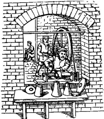
Рис. 18. Токарный станок с канатным приводом от маховика (по картине фламандского художника Иоста Альмана).
