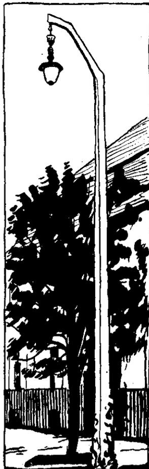
Фиг. 62—63. Железо-бетонные мачты для освещения.
