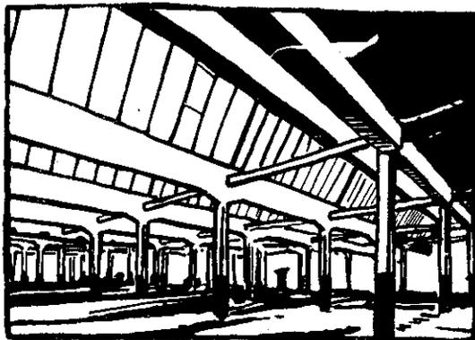
Фиг. 31. Фабричный корпус, перекрытый стропилами по системе Шед.
