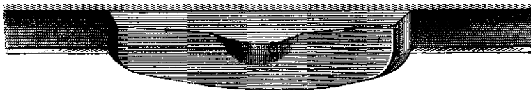
401. Соединение рельсовъ по системе Фалька.
