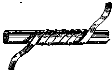
132. Обматывание проволоки лентой.
