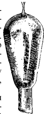
179. Стеклянный колпачекъ съ трубкой для выкачиванiя воздуха.
