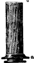
596. Трубка съ зеркаломъ и магнитомъ для зеркальнаго гальванометра.
