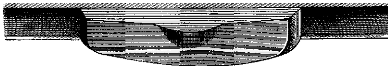
401. Соединение рельсовъ по системе Фалька.
