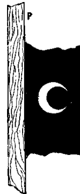
735. Угольная палочка прилегаетъ сбоку къ внутренней стенке гнезда цапфы.
