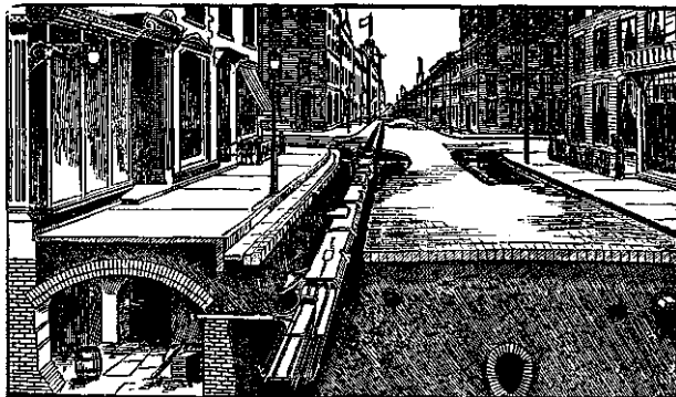
255. Желобъ для подземныхъ проводовъ въ Нью-Йорке.
