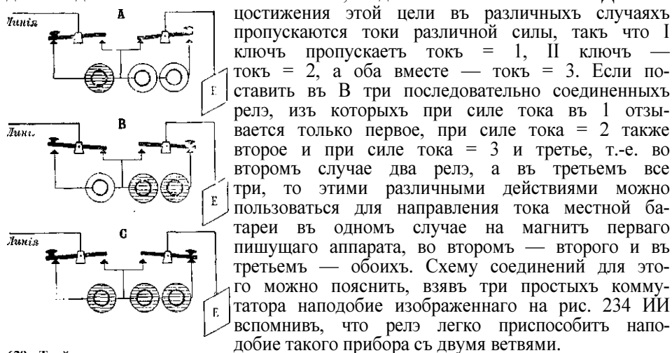
629. Тройное изменение силы тока посредством двух ключей.
