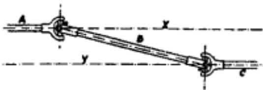
Рис. 67-5. Карданный вал: А — ведущий вал мотора; т и n — карданные сочленения (шарниры); В — карданный вал; С — вал дифференциала
