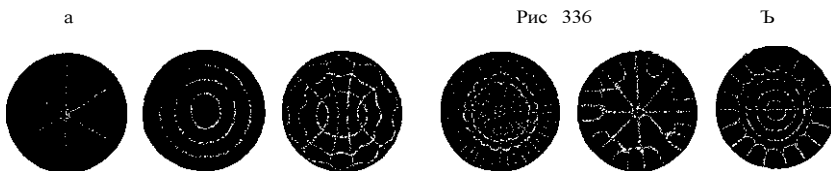
Хладниевы фигуры на круглых пластинкахъ.
