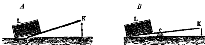
Одноплечий (A) и двухплечий (B) рычагъ.
