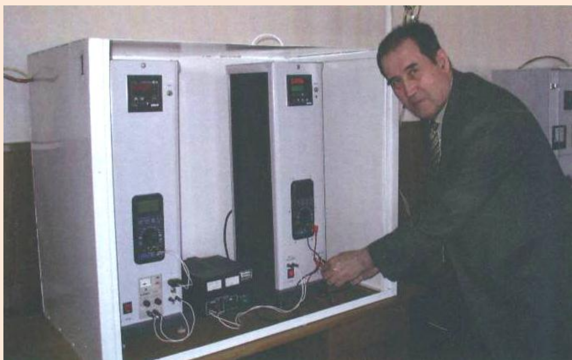
Лабораторный стенд: «Определение теплопроводности материала методом цилиндрического слоя» (ауд. В-312)
