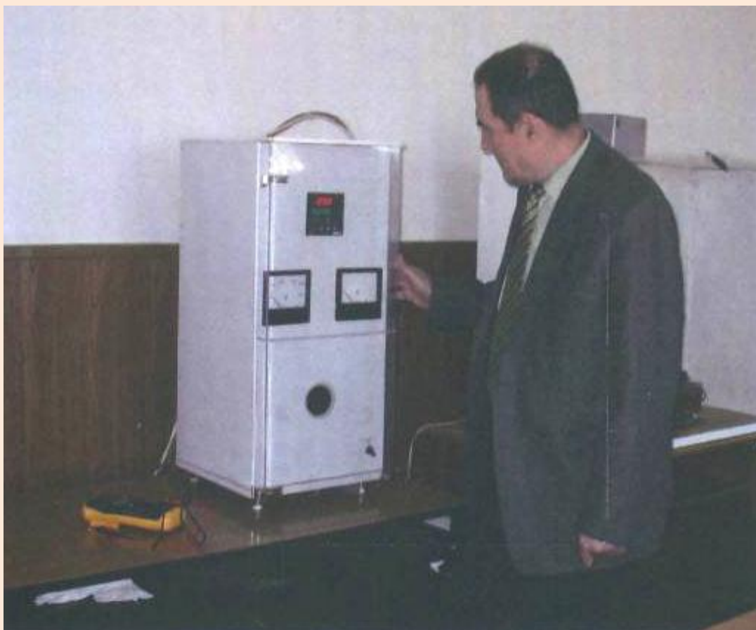
Доцент Б. П. Домрачев готовит к работе стенд «Определение коэффициента теплоотдачи при свободной конвекции воздуха» (ауд. В-312)
