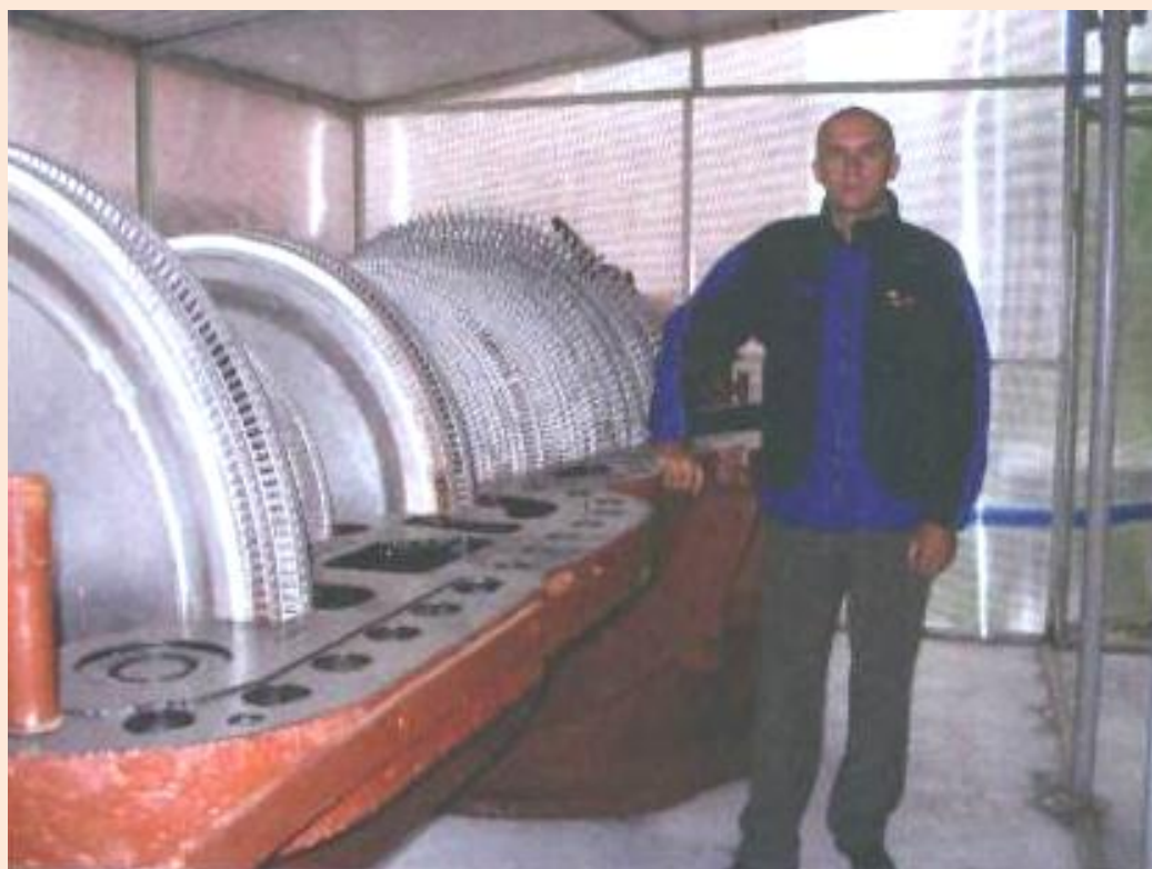
Учебный стенд на базе турбины «Инвеста» АП-4 в учебном павильоне между корпусами В и Г
